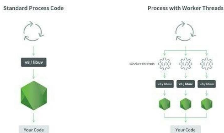
图 3-2 worker\_threads 运行架构
